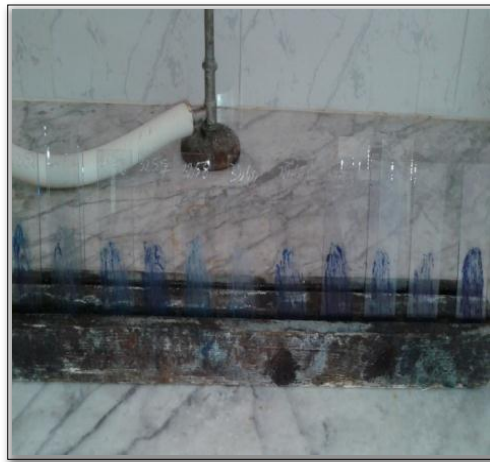
Figure 21: Séchage de lame à l'air libre sur un support en position verticale [49].
